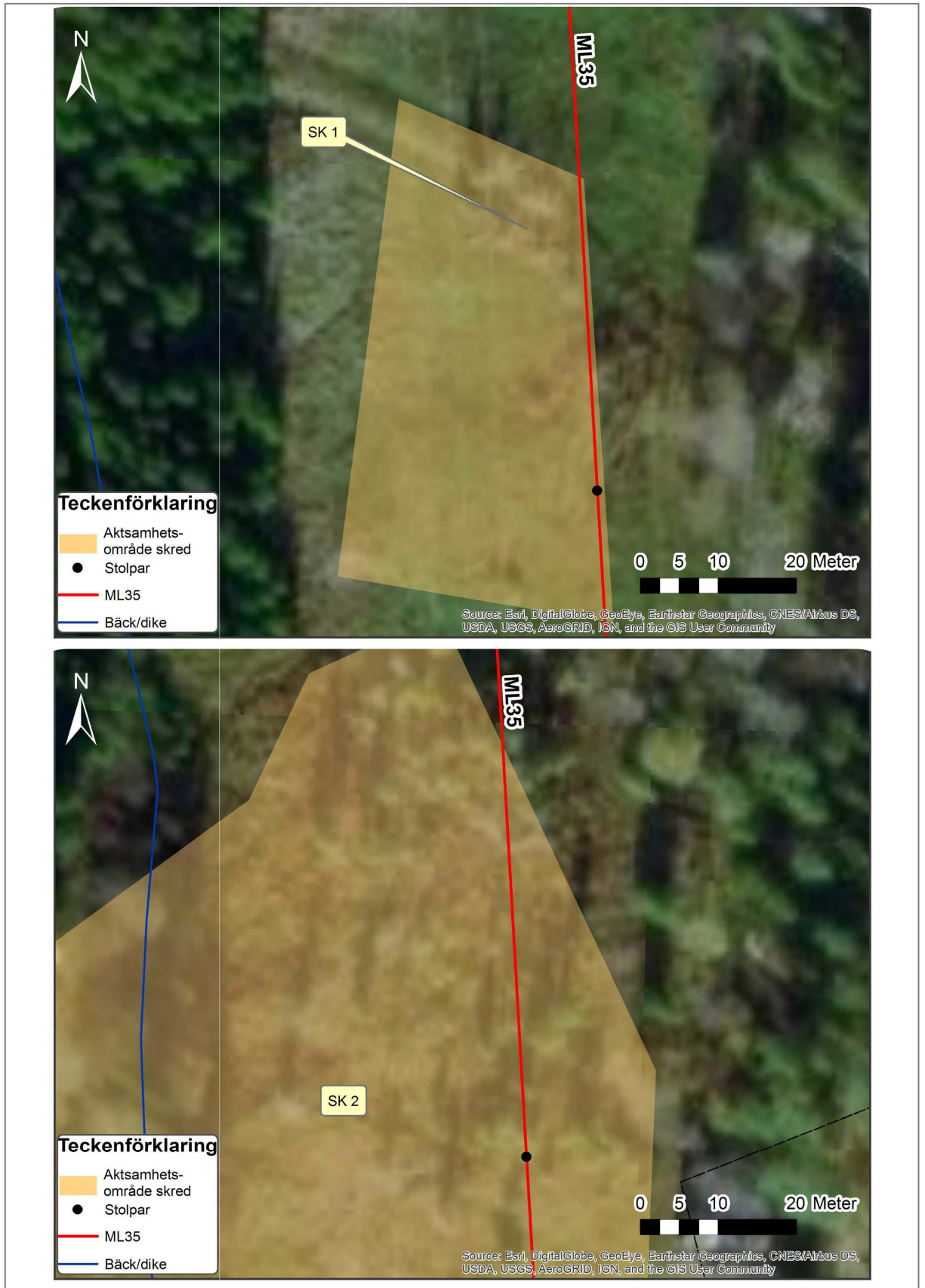
Figur 11. Aktsamhetsområde för skred i finkornig jordart med stolpar inom befintlig ledningsgata för ML35.
