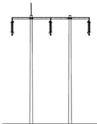
Figur 5. Exempel på portalstolpe
